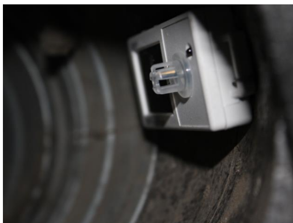
Figure 11: mesure du rendement des échangeurs de chaleur du groupe de ventilation
