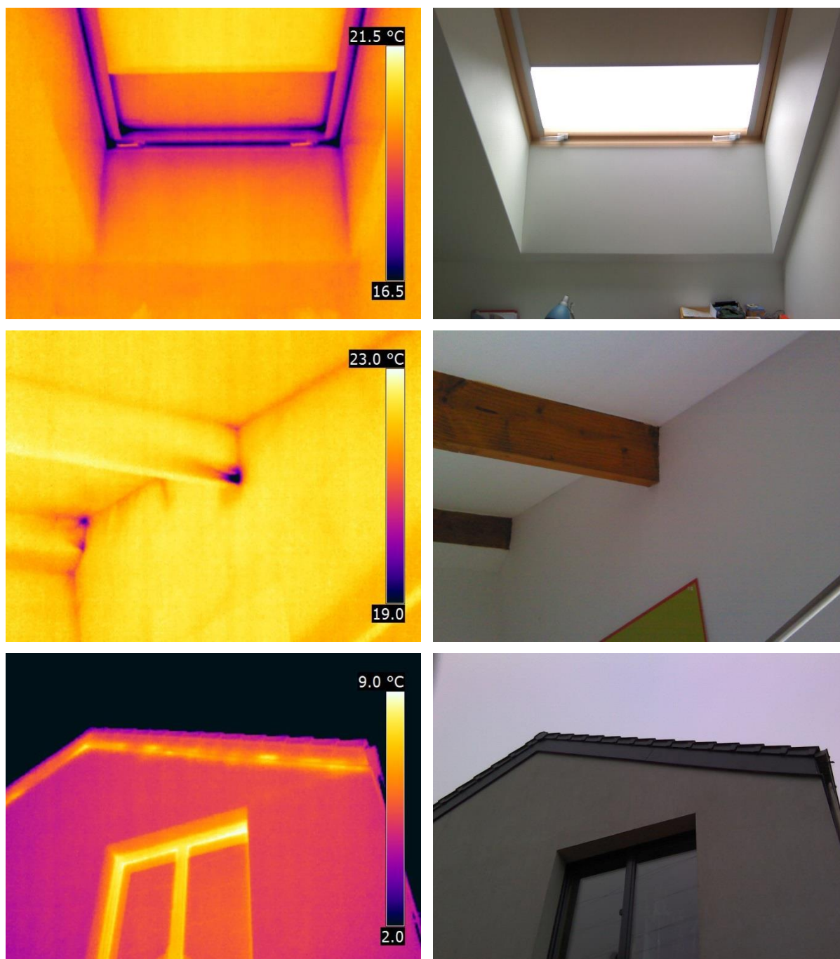
Figure 16 : Exemple d'infiltration d'air détectée par l'examen thermographique
