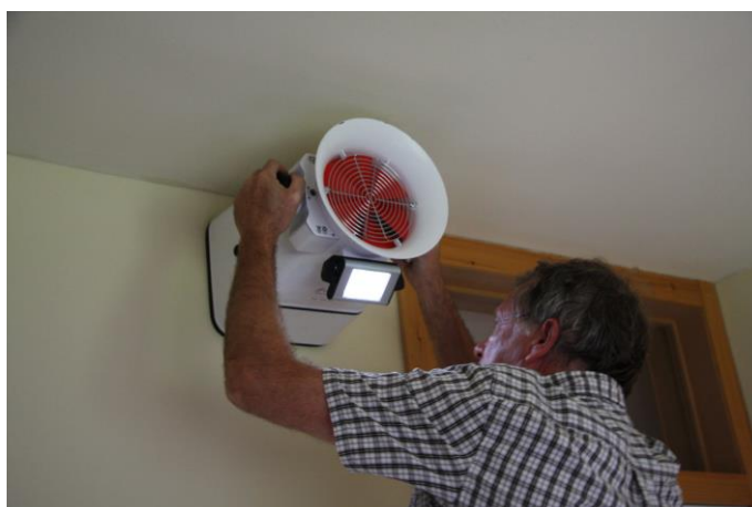
Figure 7: mesure des débits de ventilation
