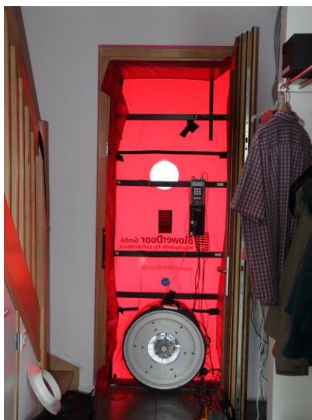
Figure 4: mesure de l'étanchéité à l'air
