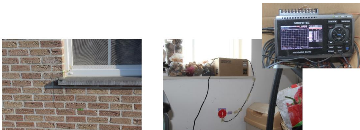
Figure 10 : Mesure du coefficient de transmission thermique d'une paroi opaque sur la maison n°18
