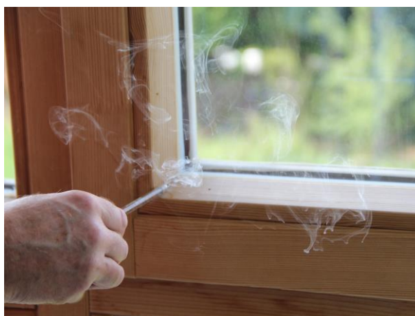
Figure 5: recherche des fuites à l'aide d'un fumigène
